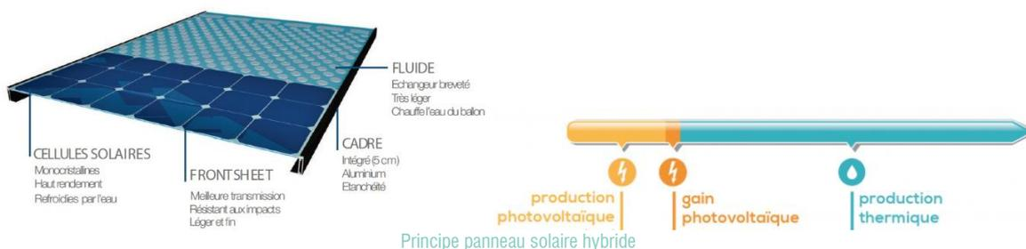
Cette solution nécessite plus de surface pour atteindre la même production que le solaire thermique classique, mais elle a l'avantage de produire de l'électricité en parallèle.
